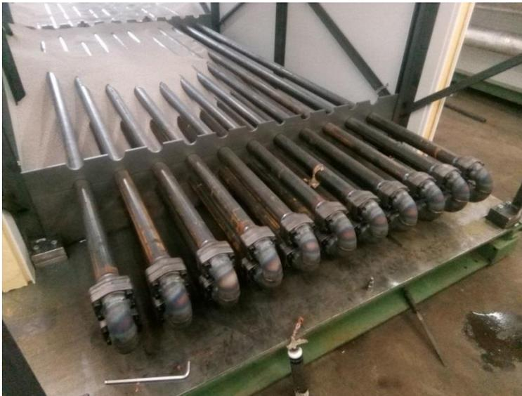
Modulrohrsystem des neuen Reaktors
