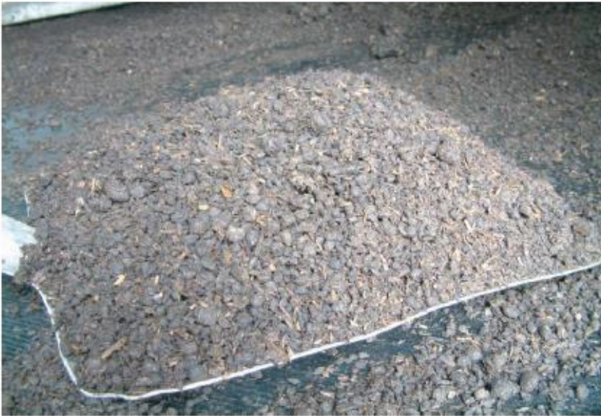
Getrockneter Gärrest (Rückmischverfahren), geringes Porenvolumen, Dichtec. 360 Kg/m 3
