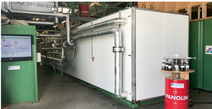
Fig. 1 Über das isolierte vertikale Rohr im Vordergrund gelangt der auf 200 °C erhitzte und auf 20 bar komprimierte Klärschlamm in den HTC-Reaktor (weisser Container). Dort verwandelt sich der Klärschlamm in einem nur vier Stunden dauernden Prozess in Kohleschlamm, aus dessen Feststoffen anschliessend durch Pressung HTC-Kohle gewonnen wird.
