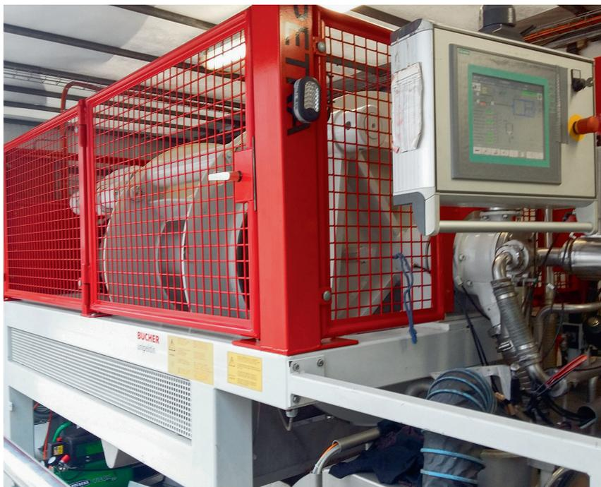
Fig. 4 Nach dem Reaktor gelangt der Kohleschlamm in eine Presse, wo nach Abfluss des Prozesswassers die HTC-Kohle mit nur noch rund 30% Wassergehalt übrig bleibt.
