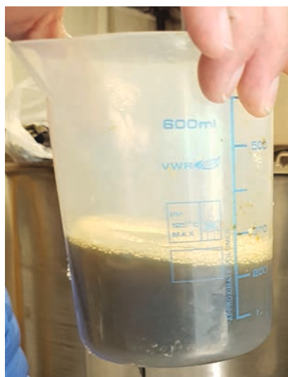
Fig. 6 Prozesswasser nach der Presse.
