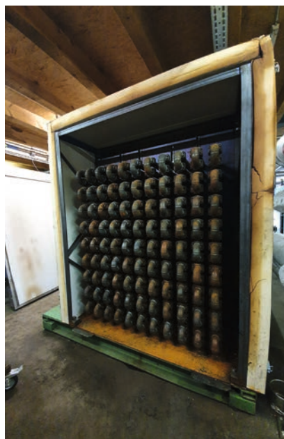
Fig. 5 Der Rohrschlangenreaktor sorgt für eine Aufenthaltszeit von vier Stunden.
