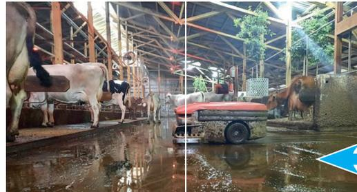
Ausgangspunkt: Laufstall mit planbefestigten Flächen und Liegeboxen, Mistschieber, Vorgrube für tagesfrische Gülle (weniger Ammoniak im Stall)
