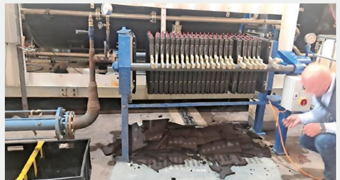
Fig. 7 Biokohle aus der Kammerfilterpresse der Pilotanlage.
