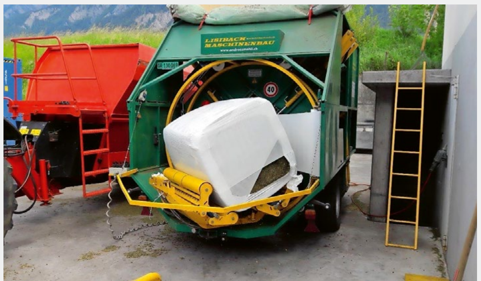
Fig. 10 Einbindung von Klärschlamm-Biokohle in lagerfähige Ballen.
