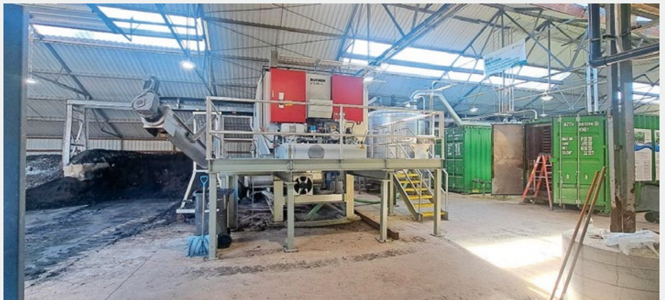
Fig. 3 HTC-Anlage auf der ARA Phoenixville, USA, mit dem Reaktor (rechts), Bucher-Presse (Mitte) und Auswurf Klärschlammkohle (links).
